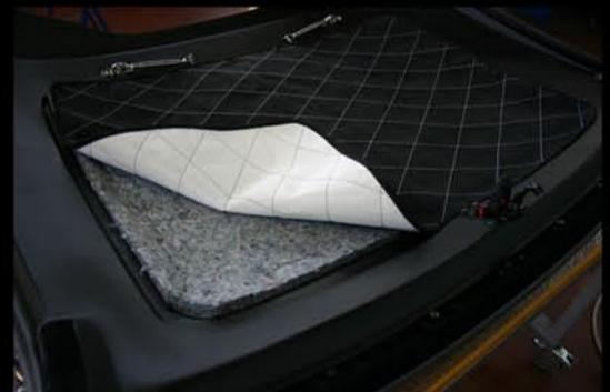
Montage mit vorderer orig. Verriegelung und am Überrollbügel hinten mit Halteplatten und Wantenspanner. Innenhimmel mit Geräusch-Dämmmatte und abgestepptem Alcantara (in verschiedenen Farben erhältlich)
