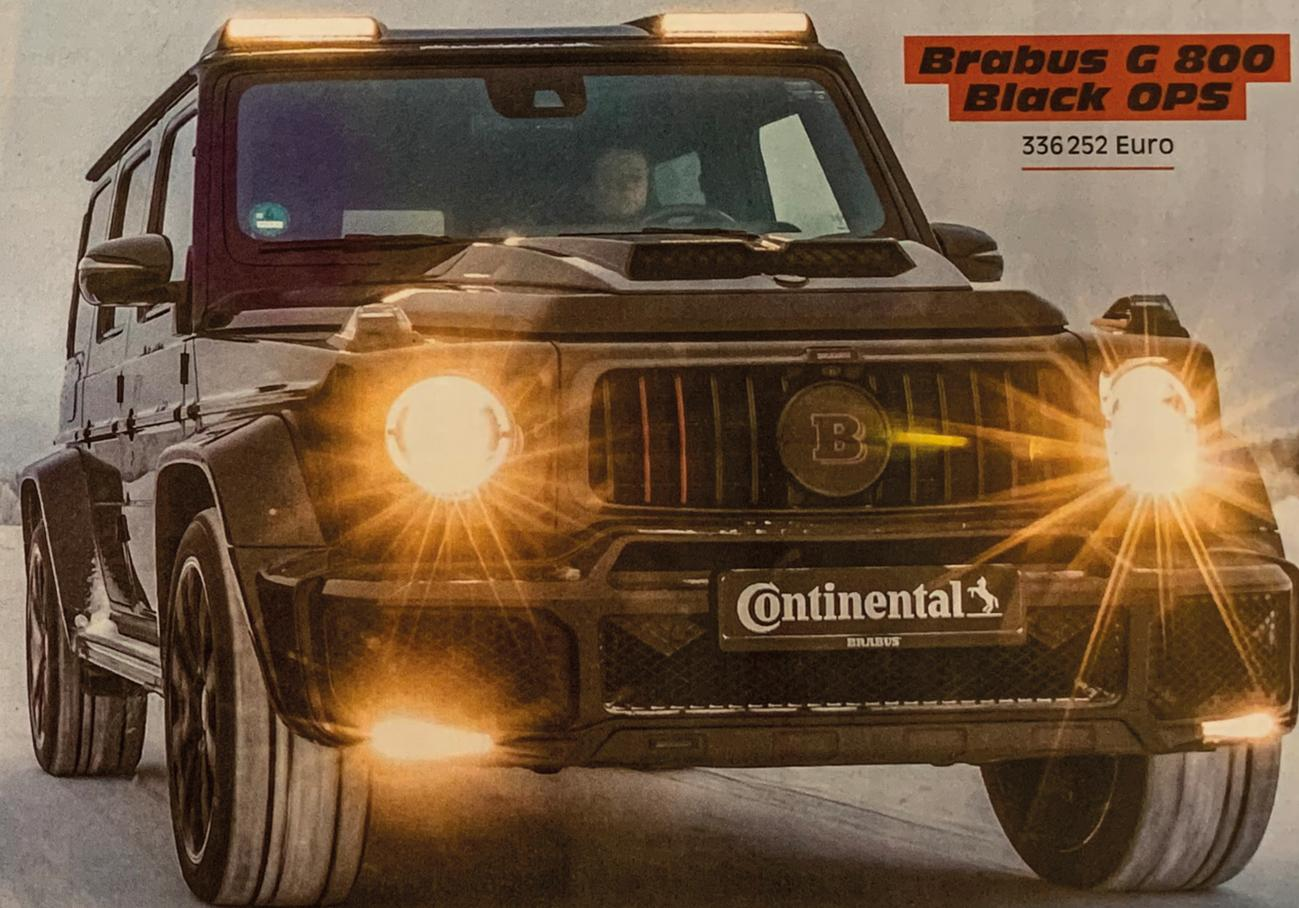
wie? Man verwendet zwei Turbolader mit größerer Verdichtereinheit (52 mm), dazu angepasste Elektronik sowie dickere Edelstahlrohre für die Auspuffanlage. Coole Verpackung gibt's natürlich auch. Typisch Brabus: breitere Kotflügel plus Trittbrett-Beleuchtung, ein mächtiger Carbon-Motorhaubenauflauf, tiefere Spoilerschürzen, LED-Fernscheinwerfer auf dem Dach, Unmengen an Leder und Alcantara im Interieur und, und, und. Kein Wunder, dass der Brabus viermal so teuer ist wie der getunte Macan.
