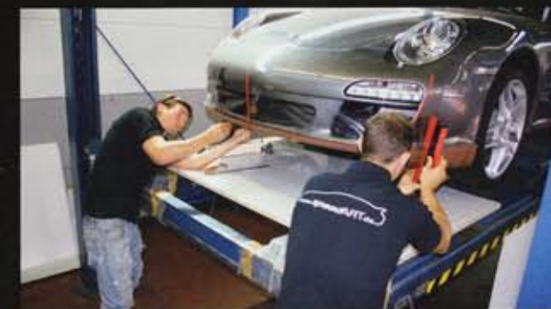
Hauseigener Modellbau: Im Bild entsteht eine Frontspoiler-Lippe für den 997 Carrera Mk2
